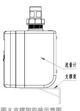
图 8 支撑架安装示意图
